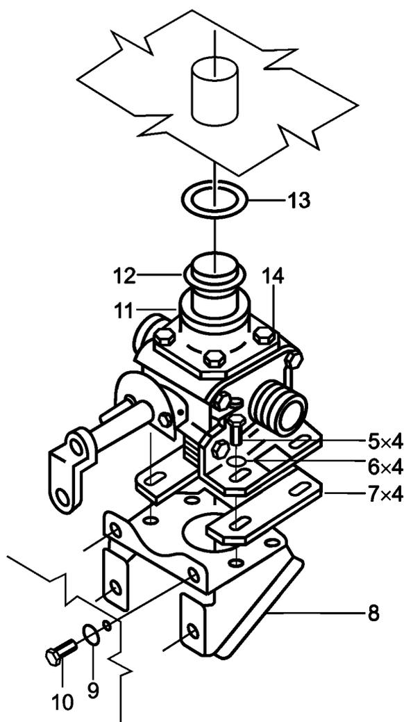
Рисунок В.1 — Пример указания количества одинаковых деталей
